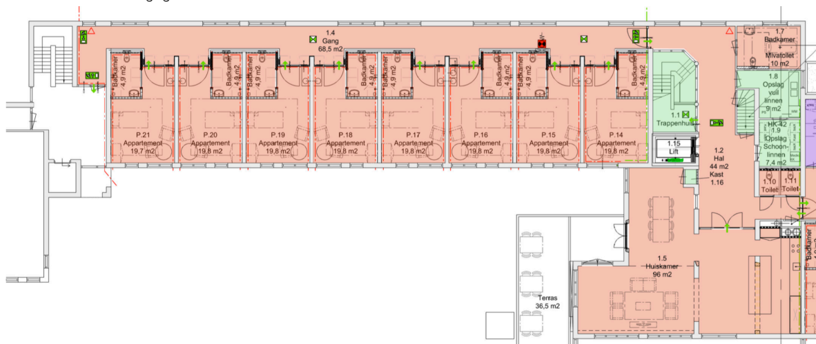
Figuur 1 eerste verdieping met links een vluchtroute (rode gebied) naar het trappenhuis van de buren (wit) dat leidt naar het aansluitende terrein.
